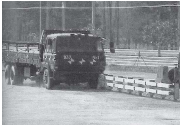
車両衝突実験(国土技術政策総合研究所にて)
