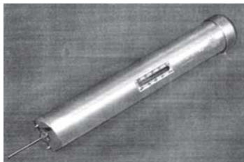
木材試験器（ピロディン） スチール製のピンを木材に貫入し、貫入深により木材の劣化を把握
