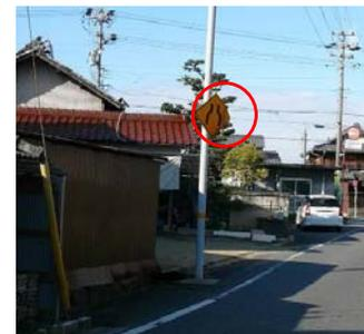
【路肩部に設置し、車が接触して標示板が曲がった例】
